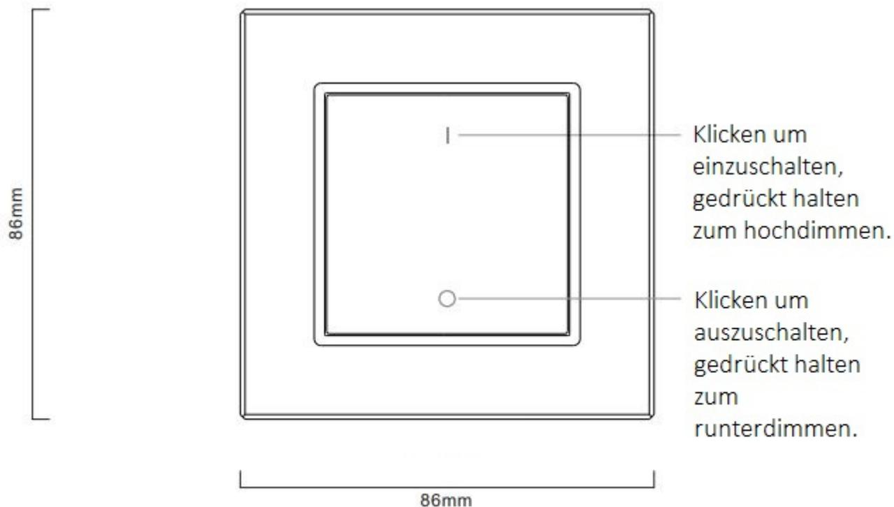
Installation an der Wand entweder über 3M Kleber oder per Verschraubung.
